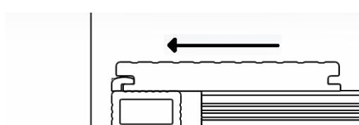
Do nich poté **naklepneeme** první řadu terasových desek (naklepávání provádíme přes hranol z měkkého dřeva přiměřenou silou, ideálně gumovou palicí). To platí, začínáme-li pokládku od zdi, nebo jiné svislé překážky. V případě pokládky z otevřeného prostoru se pokládka začíná i ukončuje stejným způsobem – viz níže „montáž poslední desky“.
