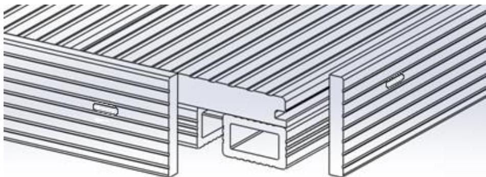
Pro ukončení systému můžeme použít krycí lištu ze stejného materiálu jako podlaha, nebo lakovanou hliníkovou lištu, postup montáže je pro obě lišty shodný. Řežeme ji pod úhlem 45°. Montáž krycí lišty na nekryté hrany systému provedeme přišroubováním samořeznými vruty do konstrukčních hranolů. Doporučujeme předvrátání (frézování) oválných otvorů pro umožnění dilatačního posuvu lišty. Rozteč šroubů by neměla přesáhnout 400 mm.
