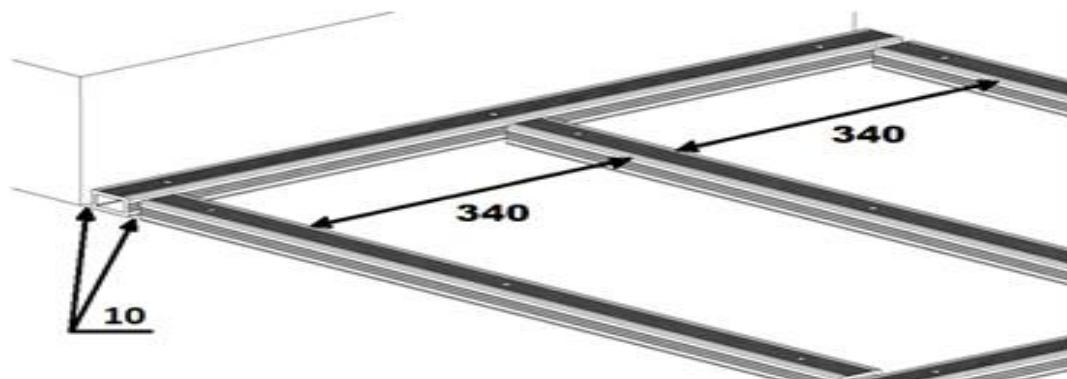
Horní otvor v konstrukčním hranolu vrtáme vrtákem **ø 8 mm**, což nám umožní prostrčení šroubů a jejich utažení. Hranoly upevňujeme k podloží pomocí hmoždinek **ø 6 mm**, doporučená délka hmoždinek je alespoň **40 mm**.
